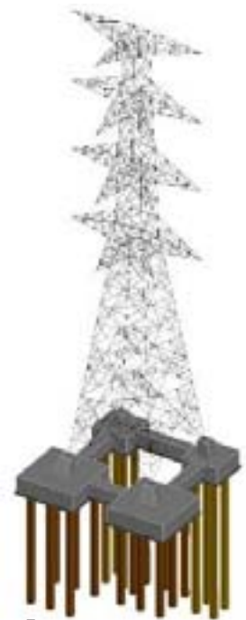
【送電施設】 鉄塔基礎の三次元解析
